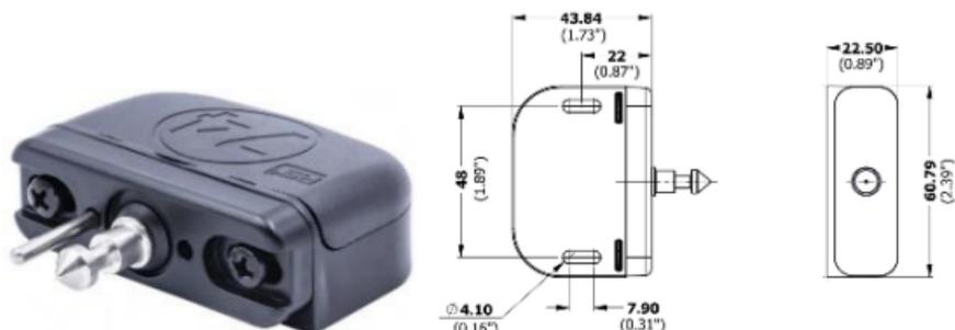
Avec un montage à 90°, le VERROU74 est utilisé principalement pour les portes battantes et les tiroirs.
