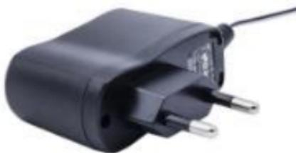
Alimentation 3Vdc 500ma fournie avec un câble de 1,5m (peut sur commande spécifique être plus long). Permet d'alimenter jusqu'à 4 serrures Abiolock.
